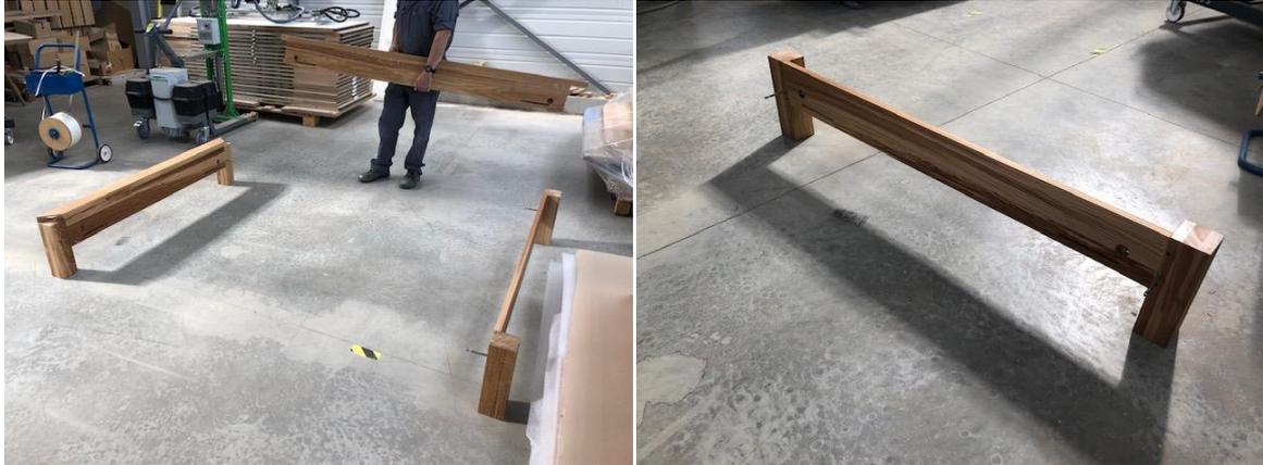
2 – les 2 pans du lit s'assemblent au moyen de deux tourillons pré positionnés et d'un système d'assemblage VIS-INSERT-ETRIER-CHAPELLE (\*)
