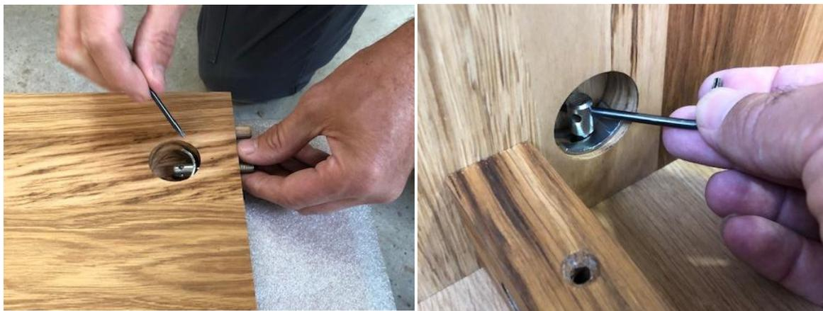
(\*) L'insert est déjà positionné. La vis est enfoncée dans le trou, la tête dépassant dans la chapelle, l'étrier qui épouse la forme de la chapelle (espace servant à visser) venant enchâsser la tête, le petit côté dans le fond. Il suffit ensuite de serrer la vis au moyen d'une tige métallique dans le sens des aiguilles d'une montre
